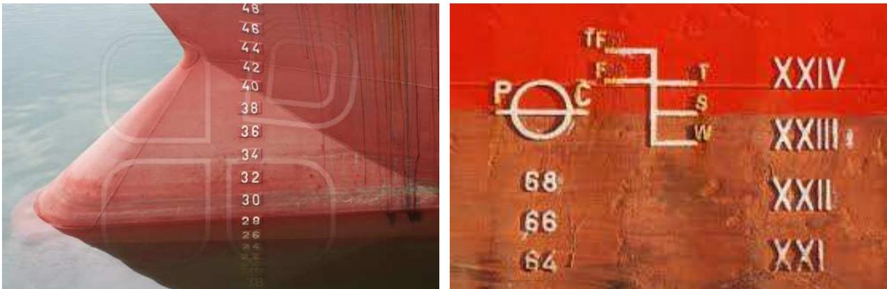
Su alcune navi le *scale dei Pescaggi*, dette anche *Targhe dei Pescaggi*, non possono essere sistemate in corrispondenza delle *Perpendicolari*, per cui vengono poste ad una certa distanza da esse. In tal caso bisognerà apportare delle *correzioni* per la non coincidenza delle scale con le *PPpp*, dal momento che i calcoli delle *Carene Dritte* sono svolti considerando la *Lunghezza tra le PPpp*.
