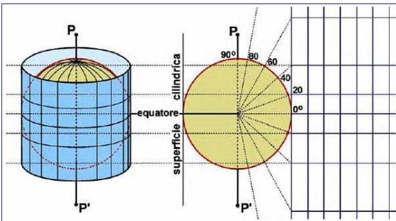
La proiezione *non è isogona e non rettifica la lossodromia*. Il cilindro è sviluppabile in un piano; se si assume per assi cartesiani, l'asse  $X$  delle ascisse la retta sviluppo dell'equatore e come asse  $Y$  delle ordinate la proiezione del meridiano fondamentale di Greenwich, si avrà:
