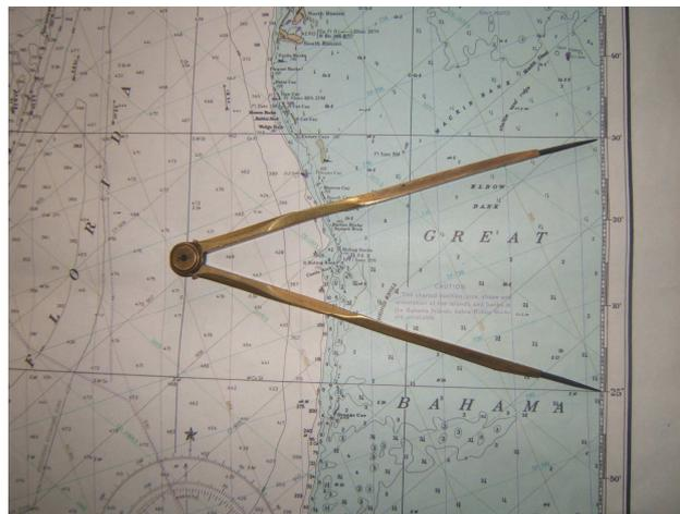
Quando la distanza fra i due punti A e B è troppo grande per essere misurata con una sola apertura di compasso, si stabilisce a piacere un'apertura di compasso contenente un numero intero di primi (*miglia*) sulla scala delle latitudini (in corrispondenza della latitudine media fra i punti A e B), facendola avanzare, con movimenti rotatori, da A verso B. L'ultimo tratto avrà evidentemente un'apertura diversa per tener conto della posizione del punto B.
