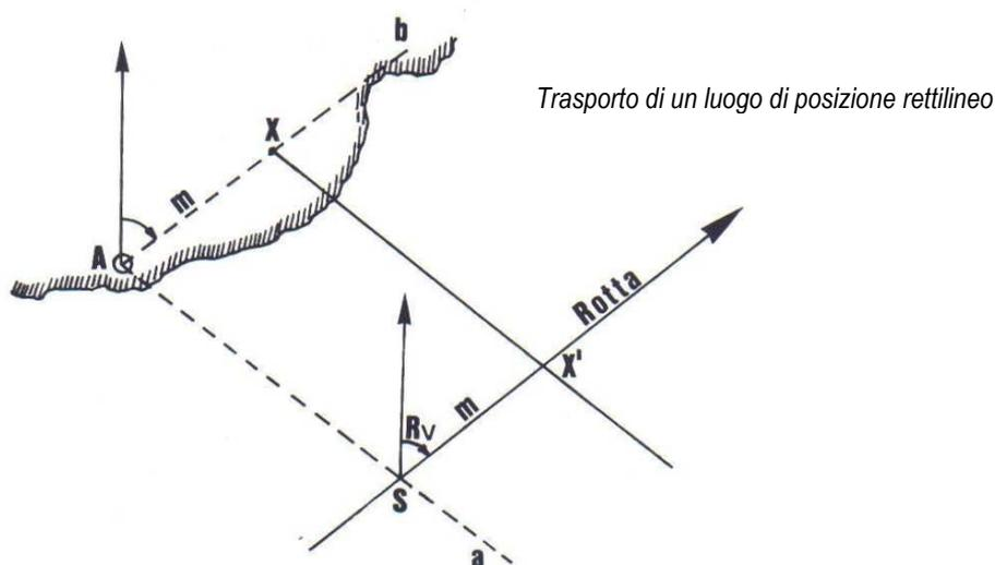
Da un punto qualsiasi del luogo di posizione, ad esempio dal punto A rilevato, si traccia una semiretta  $Ab$  avente la stessa direzione della *Rotta vera* e su di essa si stacca, col compasso, il cammino  $m$  relativo all'intervallo di tempo  $(t_2 - t_1)$ .
