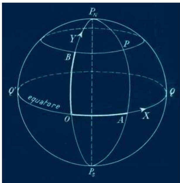
La *latitudine* di un punto, quindi, è l'*arco di meridiano*, minore di  $90^\circ$ , contato dall'equatore verso Nord, se positivo, dall'equatore verso Sud, se negativo, *compreso fra l'equatore e il punto considerato*.
