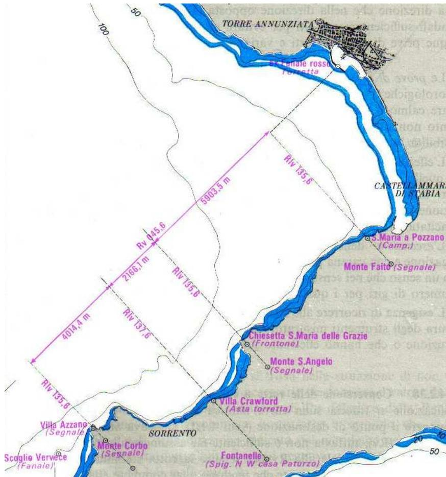
Una base misurata è delineata da alcuni allineamenti facilmente individuabili in modo che il percorso sia univocamente individuato. La base viene percorsa nel doppio senso per eliminare gli effetti di correnti. Si assume per velocità effettiva la media ottenuta su due tratti.
