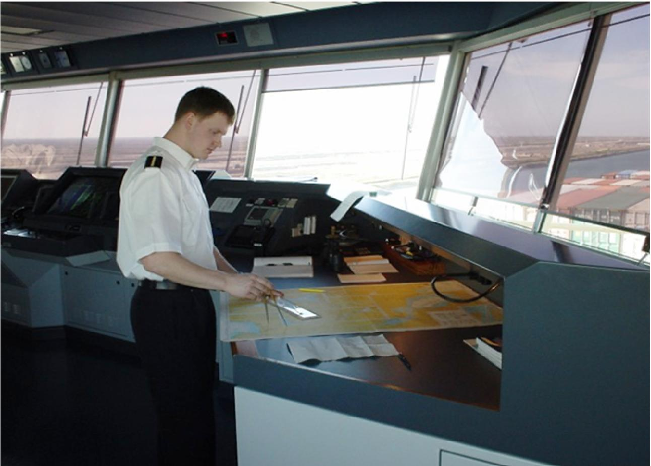
*Il carteggio è eseguito in ogni momento. Sul ponte di comando di una Nave portacontaineri, l'Allievo determina la posizione della nave (ogni 15 minuti) durante il passaggio in un canale.*
