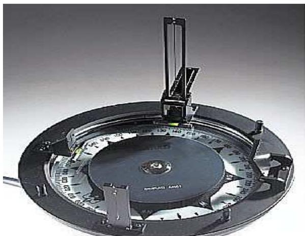
Apparecchi azimutali per la lettura dei Rilevamenti buss.
