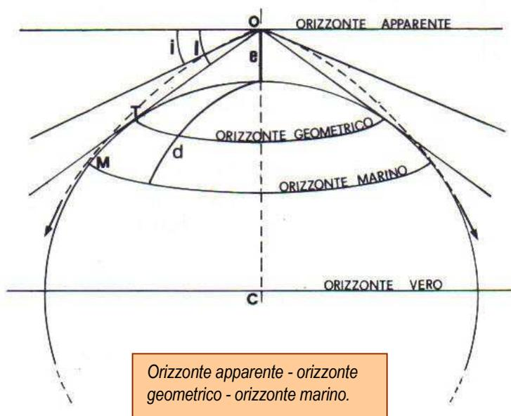
Tale fenomeno aumenta il limite di visibilità dell'orizzonte e consente ai raggi ottici di estendersi fino al punto M, oltre lo orizzonte geometrico. L'andamento della curva di *rifrazione geodetica* dipende dalla *densità* e dalla *temperatura* degli strati d'aria che sovrastano la superficie terrestre, per cui l'*orizzonte marino* non ha un raggio fisso come quello geometrico, ma *variabile* a seconda della direzione azimutale.
