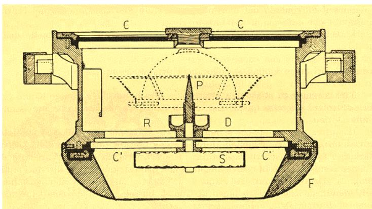
Il cappelletto poggia su un *perno* dalla punta dura (*acciaio, iridio*) fissato al centro del *mortaio* o *bossolo*, il quale è appesantito da zavorra nella parte inferiore e poggia, mediante una *sospensione cardanica*, sulla *chiesuola* montata nel piano longitudinale della nave. All'interno del mortaio, in corrispondenza dell'asse longitudinale della nave, è sistemata la *linea di fede* che consente la lettura della *Prora*.
