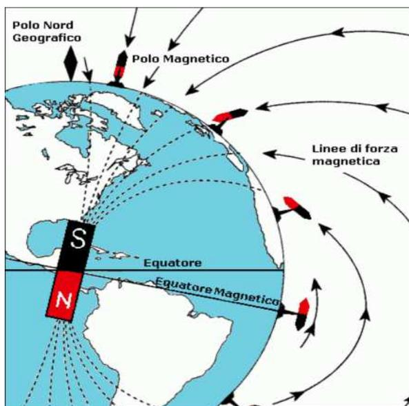
Il campo magnetico terrestre. Possiamo considerare la Terra come un grande magnete orientato con il polo sud verso il Polo magnetico Nord ( $\varphi = 71^\circ N$ ;  $\lambda = 96^\circ W$ ) e con il polo nord verso il Polo magnetico Sud ( $\varphi = 73^\circ S$ ;  $\lambda = 156^\circ E$ ). Una bussola verticale, chiamata inclinometro, si orienta sempre tangenzialmente alle linee di forza.
