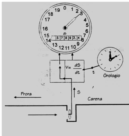
Sfruttando un principio di elettrodinamica, l'elica funziona come tachimetro, cioè misuratore di velocità.
