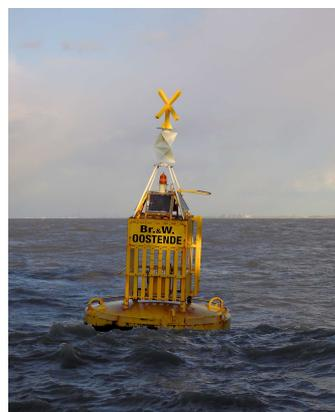
Dopo l'affondamento della Nave "Tricolor" nello Stretto di Dover avvenuto nel 2002, nonostante i ripetuti avvisi (via radio) e il segnalamento con boe luminose, molte navi urtarono il relitto. Si creò allora un nuovo tipo di boa che indicasse i relitti affondati *di recente* e pericolosi per la navigazione.
