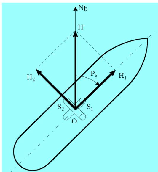
Disposizione dei sensori fluxgate a bordo di una imbarcazione e scomposizione del campo magnetico.
