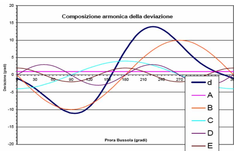
La formula approssimata della deviazione, quando sono noti i coefficienti, permette di determinare il valore della deviazione al variare della  $P_b$ , sommando i valori delle singole armoniche per ogni  $P_b$ .
