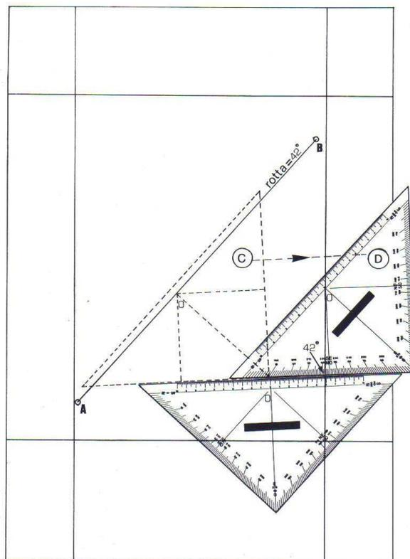
Sono costruite con materiale plastico trasparente ed hanno l'ipotenusa di circa 28 cm. di lunghezza. La loro particolarità è quella di portare una doppia graduazione su entrambi i cateti, di grado in grado, da 0° a 180° in un senso e da 180° a 360° in senso opposto. All'angolo retto della squadretta corrispondono i valori 90° e 270°.
