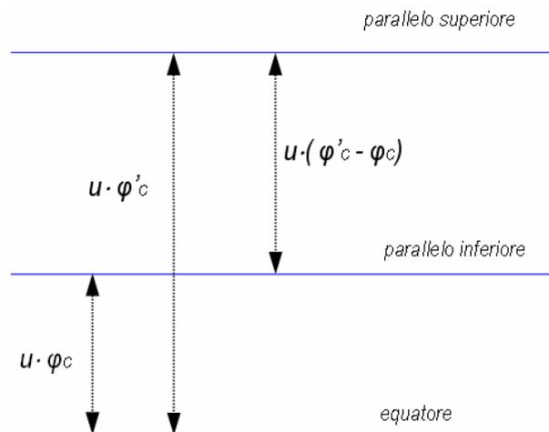
Il parallelo di latitudine  $\varphi = 30^{\circ} N$  è posto alla distanza dal parallelo  $\varphi = 27^{\circ} 40' N$  di  $(1876,8 - 1117,8) \cdot 0,469 = 356 \text{ mm}$ . Allo stesso modo si procede per gli altri paralleli.
