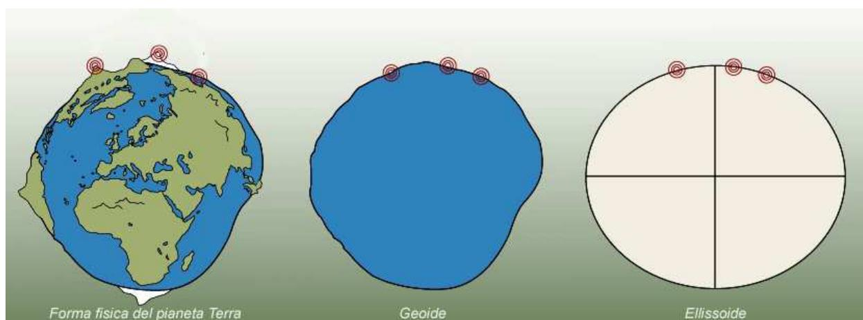
Le forze che determinano l'equilibrio della superficie geoidica sono: 1) la *Forza di gravitazione* universale o di Newton, diretta verso il centro di massa della Terra; 2) la *Forza centrifuga* dovuta alla rotazione della Terra. La risultante tra la *Forza di gravitazione* e la *forza centrifuga* è la *Forza di gravità* la cui direzione si chiama *verticale* ed è geometricamente individuata dal *filo a piombo*.
