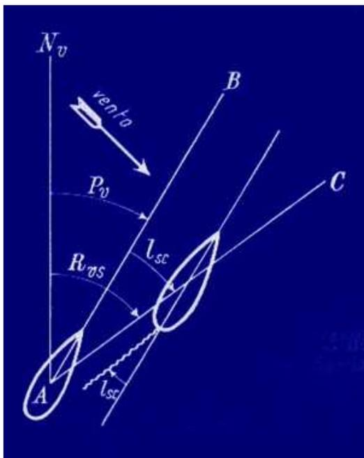
In pratica è molto facile misurare l'angolo di scarroccio. Esso è l'angolo che la scia della nave forma con la direzione del piano longitudinale.
