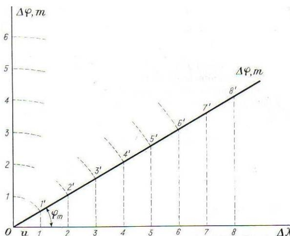
Dall'origine della scala delle longitudini si traccia un raggio, facente con la detta scala un angolo uguale alla *latitudine media* della zona da rappresentare. Dai numeri di divisione della scala delle longitudini s'innalzano tante perpendicolari alla scala stessa, le quali incontrando il raggio inclinato determinano le divisioni della *scala delle latitudini* o delle *distanze*.
