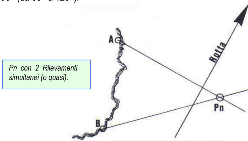
Tracciate le semirette di rilevamento sulla carta nautica, il Punto-nave è dato dall'intersezione dei due luoghi di posizione. Bisogna ricordare che le due semirette di rilevamento vanno tracciate con il Rilevamenti opposti, dopo aver corretto i  $Ril_b$  in  $Ril_v$  con le note relazioni:
