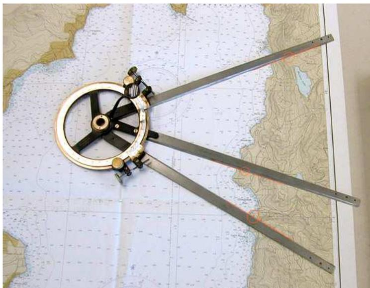
Strumento utilizzato nelle operazioni di carteggio. La sua funzione è quella di determinare rapidamente, e senza calcoli, la posizione della nave sulla carta nautica in prossimità della costa mediante la misura di 3 rilevamenti di altrettanti punti costieri. Lo staziografo risolve il problema di Snellius-Pothenot, noto anche come "punto a vertice di piramide".
