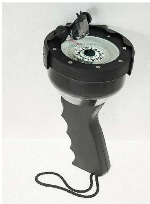
Strumento usato a bordo di piccole unità navali per misurare rilevamenti magnetici di navi, di punti cospicui sulla costa, quali fari, sommità di monti, ecc.
