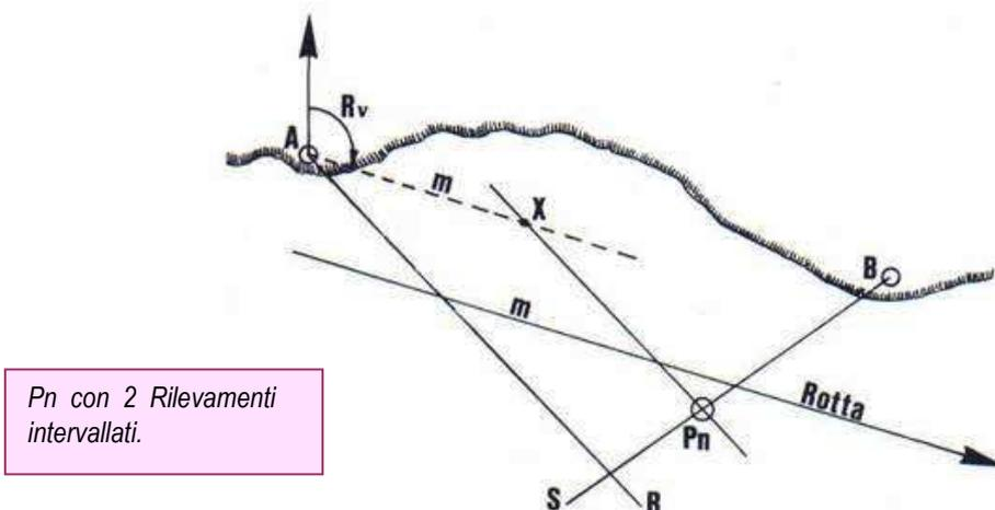
Dal punto B si traccia la semiretta al tempo  $t_2$ , con il  $Rilv_B$ . Dal punto A, o da un qualsiasi altro punto della prima semiretta di rilevamento, si traccia la parallela alla direzione della rotta e su di essa si riporta la lunghezza del cammino  $m$  percorso nell'intervallo di tempo  $(t_2 - t_1)$  fra i due rilevamenti. Per il punto X si traccia una retta parallela ad AR che intersecherà la retta BS nel punto Pn. Tale intersezione rappresenta il *Punto-nave* all'istante  $t_2$ .
